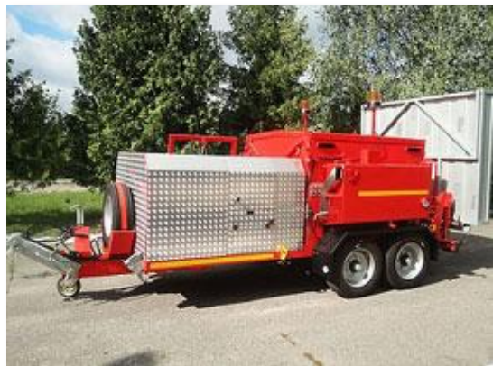
Ремонт инфракрасным нагревом
