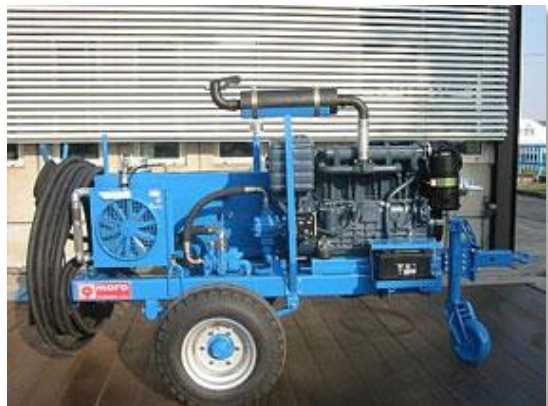
Перекачивающие шламовые насосы
