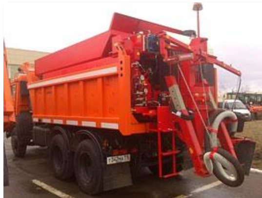
Ремонт дорог пневмонабрызгом
