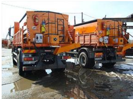
Термоконтейнеры для готового асфальта
